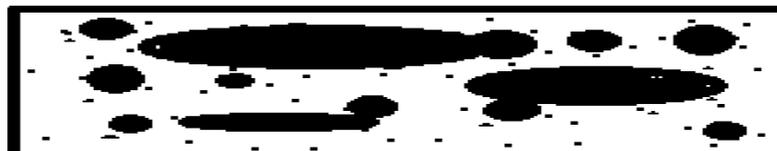
Инородные включения разных типов полимеров и прочего + неравномерное распределение углерода
