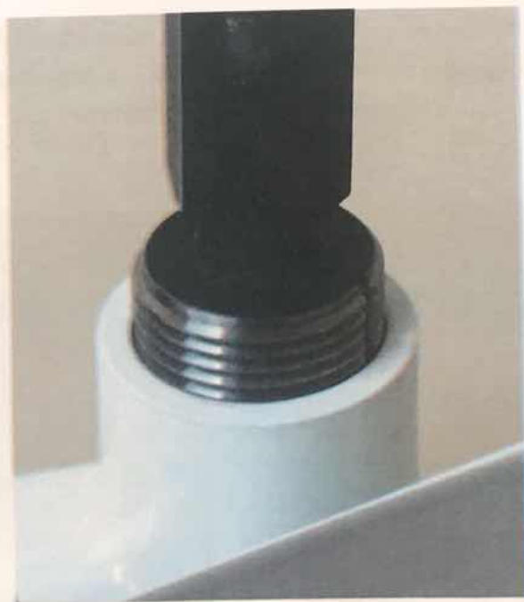
Фото №№ 101. Положение резьбового проходного калибра в отверстии № 2 радиатора № 7.
