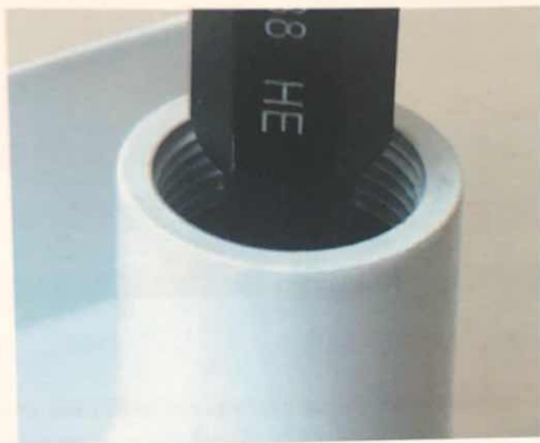
Фото № 96. Положение гладкого непроходного калибра в отверстии № 3 радиатора № 6.
