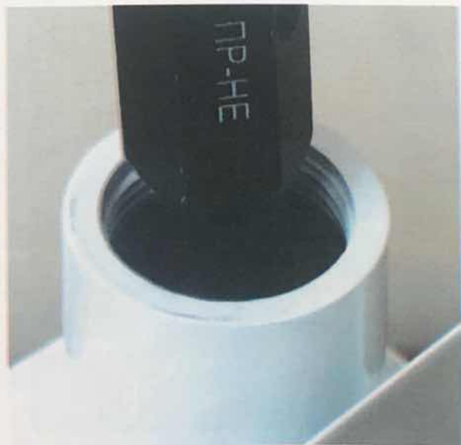
Фото № 88. Положение гладкого непроходного калибра в отверстии № 2 радиатора № 5.
