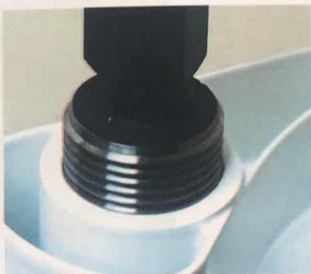
Фото № 81. Положение резьбового проходного калибра в отверстии № 1 радиатора № 4.
