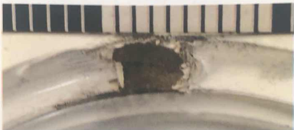
Фото № 119. Общий вид дефекта на поверхности резьбы отверстия № 3 радиатора № 8.
