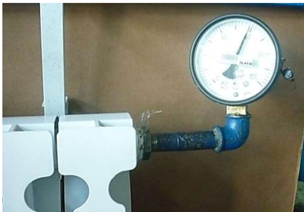
Фото 4. «STI bimetal 500/80» Гидравлические испытания. Потеря герметичности при давлении P = 60 бар.
